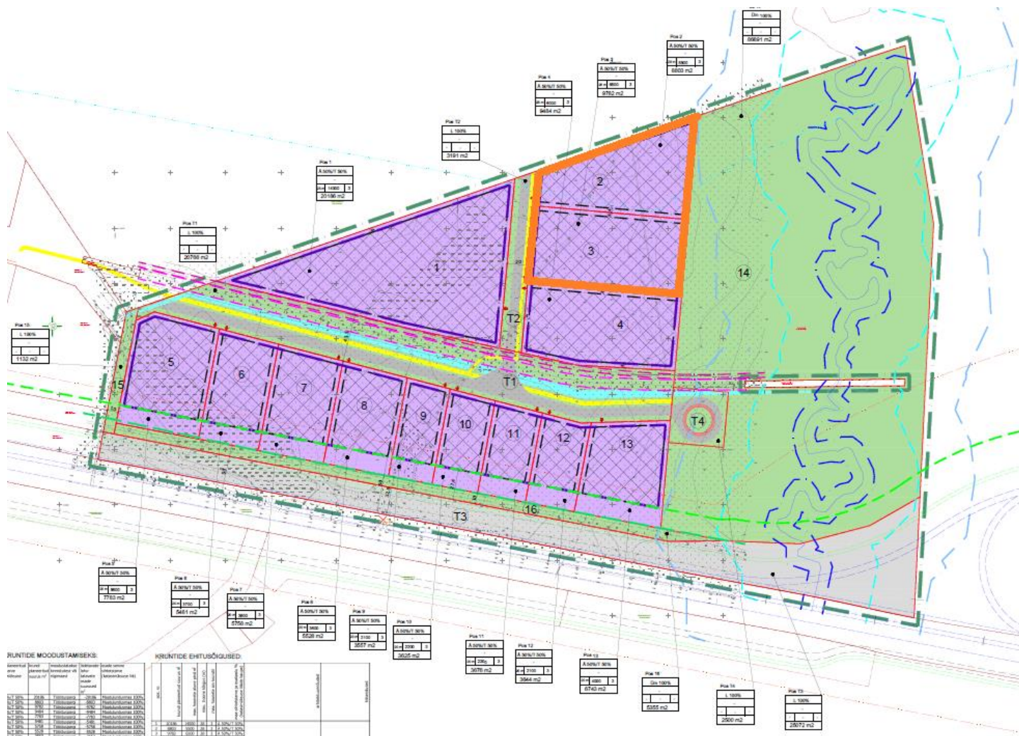
JOONIS 2 JÕHVI ÄRI- JA LOGISTIKAPARGI KRUNTIDE JAOTUS (ÄRI- JA TOOTMISMAA KRUNDID MÄRGITUD LILLA VÄRVIGA, TRANSPORDIMAA KRUNDID HALLIGA JA ÜLDKASUTATAVA MAA ROHELISEGA, LOOMETÖÖSTUSE INKUBAATOR PIIRITLETUD ORANŽIGA) 7
